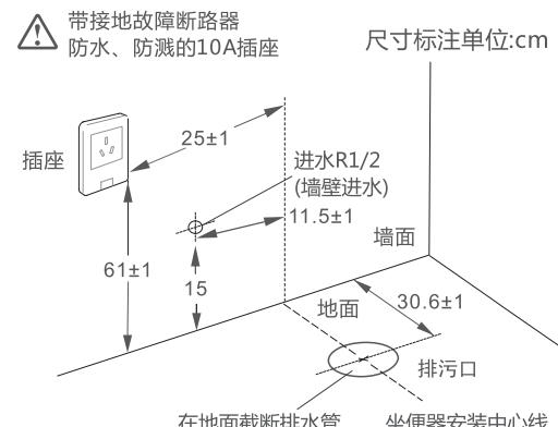
注意 安装角阀前先排清进水管道内的砂石
