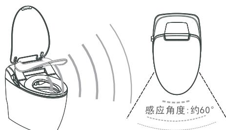
遥控器打开自动翻盖功能后，液晶显示
